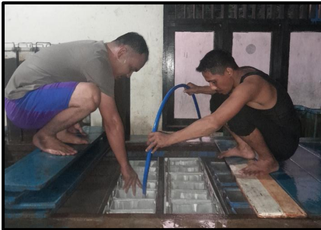
Gambar 9. Pengisian air ke cetakan balok
