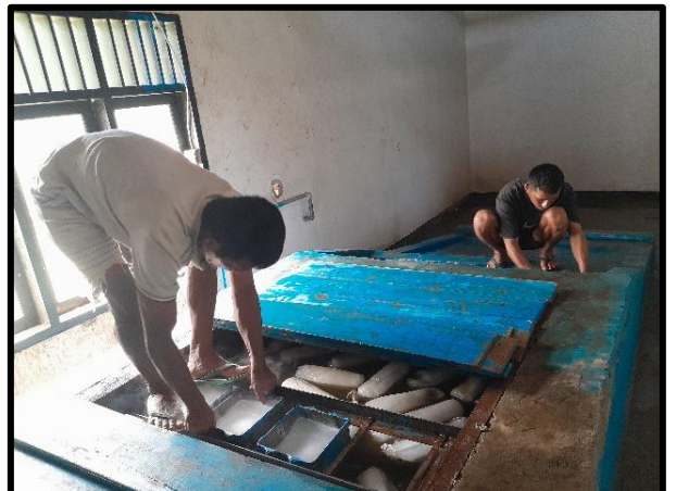
Gambar 10. Proses mengeluarkan es balok dari bak proses
