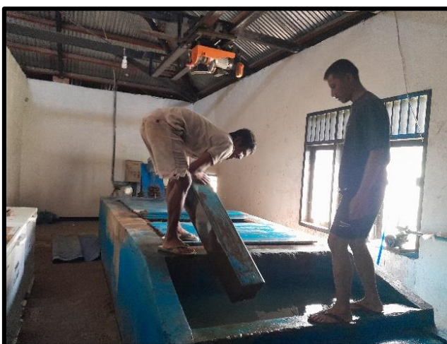
Gambar 11. Pelepasan es balok dari cetakan
